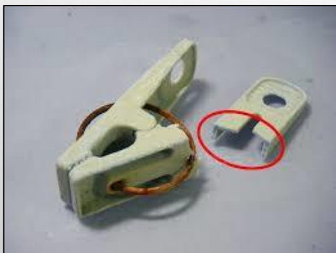
紫外光による劣化 写真：洗濯ばさみ 材質：PP
