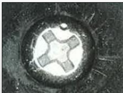
四塩化炭素による ソルベントクラック 材質：PC
