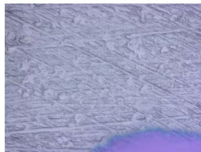
弊社では、異物の大きさに合わせて、上記の方法で鮮明な写真を撮影しご報告いたします。上記のように外観の大きさ、色調、付着の状態などを詳しく観察を行い、次の分析に進みます。有機物であれば FT-IR、無機物であれば SEM/EDX で分析を行います。
